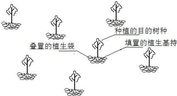
图 D.12 边坡植生袋围堰造穴种植乔木树种示意图
